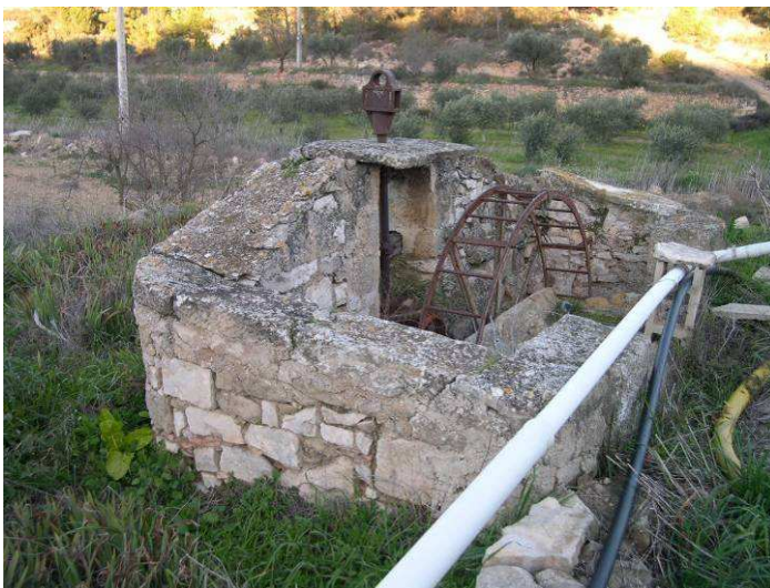
Foto 3. A la vall dels Prats, una de les nombroses antigues sínies o cadufos que s'utilitzen des d'antic per extreure aigua freàtica, fins a primers dels anys 70 amb tracció animal i ara amb electricitat.
